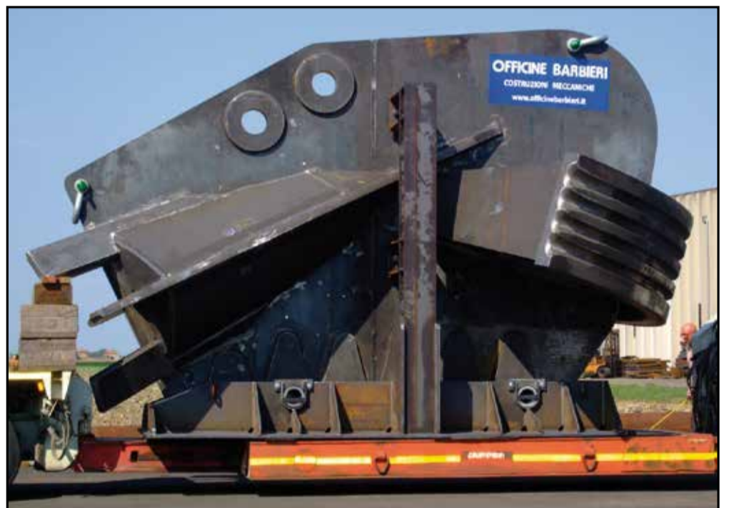
Il giunto che sostiene i cavi d'acciaio
