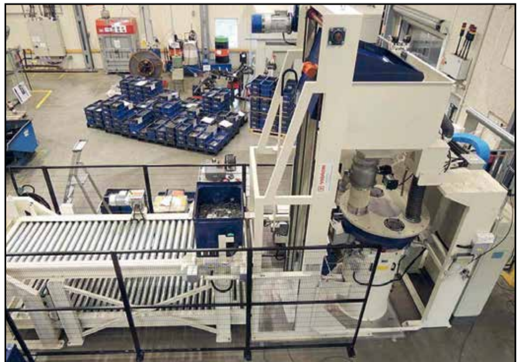
Impianto per il trattamento superficiale rondelle autobloccanti
